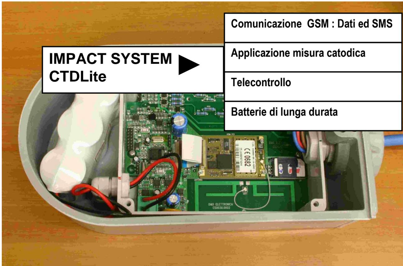
Il sistema CTD Lite è strutturato per il telecontrollo dei sistemi di protezione catodica delle reti di distribuzione del gas, in conformità a quanto definito dalle linee guida APCE.
